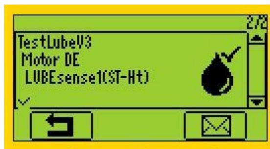
Die nächste Position in Ihrem Arbeitsauftrag / der Untersuchung ist die Erfassung Statischer Daten der selben Anlage. Da Daten bereits erfasst und die Schmieraufträge durchgeführt wurden, kann diese Position deutlich als „Erledigt“ gekennzeichnet werden und Sie können mit der nächsten Anlage fortfahren.
