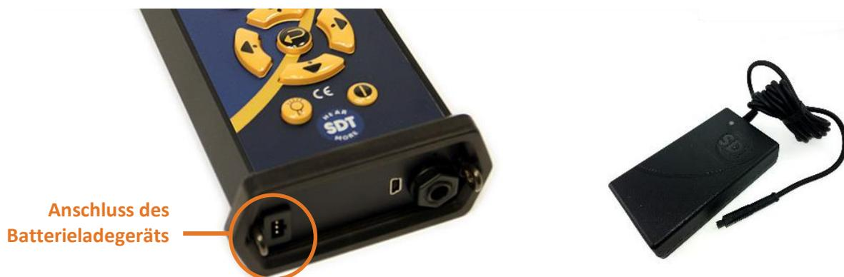
Die Aufladedauer beträgt in der Regel 6 Stunden. Wenn die LED des Ladegeräts grün leuchtet, ist der Akku des LUBExpert vollständig geladen.
