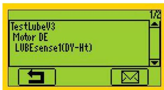
Wenn die Dynamische Messung ausgewählt wurde, erfasst Ihr SDT270DU LUBExpert automatisch Dynamische Daten von Ihrer Erst- und Letzten Lesung. Der Prozess ist komplett gleich wie zuvor beschrieben, mit dem Unterschied, dass Sie zusätzliche äußerst wertvolle Daten für die Zustandsüberwachung des Lagers zur Verfügung stellen.
