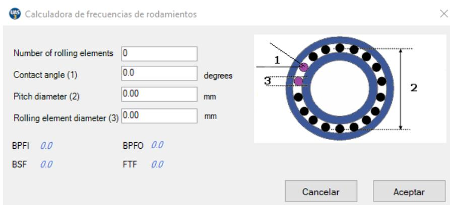
Cada rodamiento tiene sus propias características geométricas a partir de las cuales se calculan las siguientes recurrencias/frecuencias. Suponiendo la captura con la configuración y especificaciones apropiadas del sensor, estas firmas periódicas podrían aparecer en el espectro y / o en la forma de onda de tiempo.
